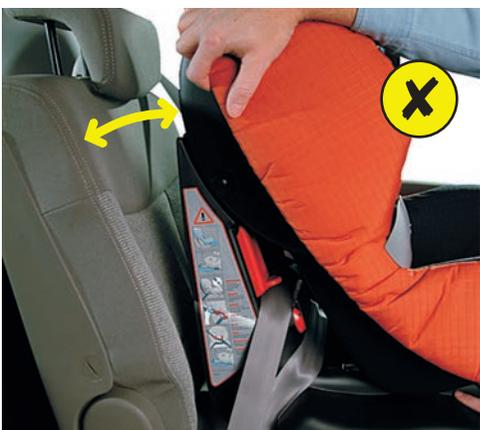
Montaggio instabile; il seggiolino traballante non offre una protezione ottimale in caso di incidente.
