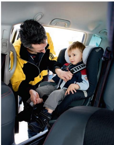
Se le cinghie sono allentate possono scivolare sulle spalle e non trattenere sufficientemente il bambino in caso di urto. Badare a che siano saldamente tese.
