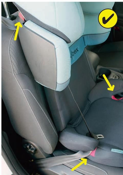
Un rialzo con schienale assicura una regolazione ottimale della cintura sulle spalle (in altezza) e sui fianchi (cornetti).
