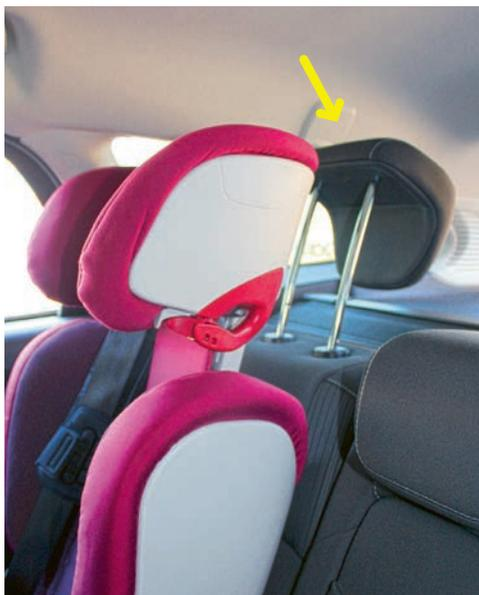
Qualora il poggiatesta impedisce il montaggio del seggiolino, conviene toglierlo e rifissarlo all'indietro. Non vi sono così dei pezzi sparsi nel veicolo e il seggiolino viene ad aderire perfettamente al sedile.
