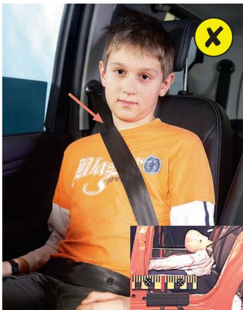
Allacciato alla meno peggio: la cintura a 3 punti scorre male. In caso di incidente il ragazzino rischia delle gravi lesioni al collo e all'addome.
